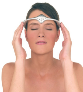
Slika 2. Pripomoček za kranialni TENS z vgrajeno elektroniko in baterijami s prikazom uporabe.
